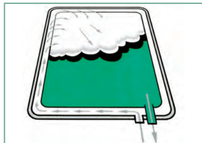
Схема примусового видалення повітря з апарату з комбінованою продувкою
